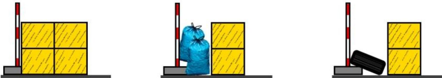
**Variante 1** ist ein Beispiel für eine ungenügende Sicherung.. Durch die bloße Aneinanderreihung der Strohballen entsteht hier eine Mauer, die eine sehr geringe Federwirkung aufweist. Die Wahrscheinlichkeit von Verletzungen beim Einschlag ist hier erhöht.
